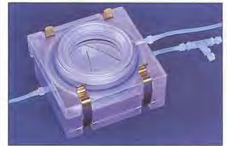
Abb. 5: Der neu konstruierte Perfusionskulturcontainer ermöglicht eine optische Kontrolle durch die im Deckel eingelassene Glasabdeckung. Über einen speziellen Port an der Bodenseite des Containers erfolgt die physiologische Kontrolle des Mediums.
