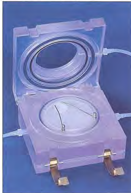
Abb. 4: Der Gewebeträger wird in einen speziell konstruierten Perfusionskulturcontainer eingesetzt. Medium wird an der Bodenseite eingeleitet und am Deckelteil abgeführt.
