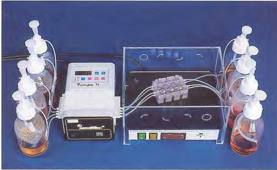
Abb. 2: Die Zuführung von frischem Kulturmedium in einen Perfusionskulturcontainer erfolgt über dünne Silikonschläuche und Mithilfe einer Peristaltikpumpe. Eine Thermoplatte mit einer speziellen Abdeckhaube sorgt für die Temperierung der Kulturen.
