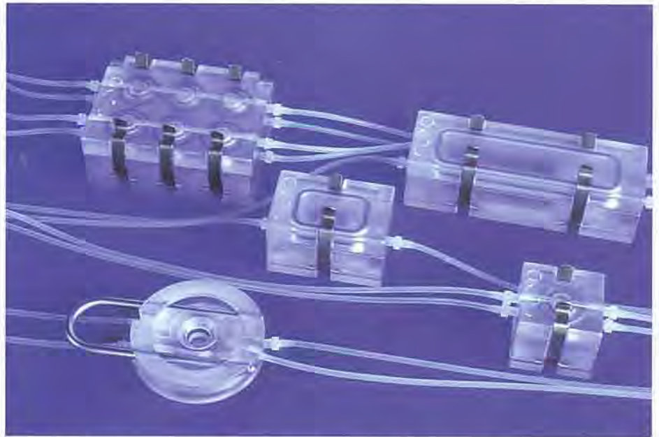
Abb. 2: Perfusionscontainer für die Herstellung von künstlichen Geweben. Nach dem Anwachsen der Zellen auf einer geeigneten Unterlage können die Gewebeträger in Kulturcontainer eingesetzt und permanent mit frischem Medium durchströmt werden. Dadurch lassen sich beliebige organtypische Situationen während der Kultur simulieren. In Mikroskopkammern lässt sich die Entwicklung der Gewebe beobachten.
