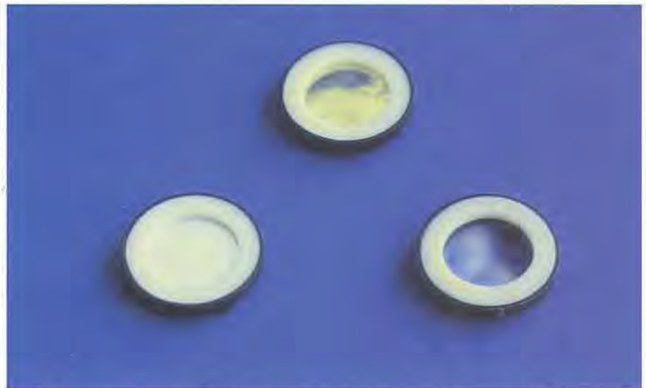
Abb. 1 (a,b): Gewebeträger gibt es in ganz unterschiedlichen Formen und Funktionen. (a) MINUSHEET-Gewebeträger (oben) bestehen aus einem schwarzen Haltering und einem weißen Spannring. Dazwischen wird eine individuell ausgesuchte Zellunterlage mit einem Durchmesser von 13 oder 47 mm eingelegt. Durch die Wahl der Unterlage kann entschieden werden, ob die Kulturen plan oder dreidimensional expandieren sollen. Die Gewebeträger werden autoklaviert, danach die Zellen aufpipettiert. (b) Spezieller Gewebeträger, auf dem ein kleines Stück Nierengewebe aufgespannt ist (unten).
