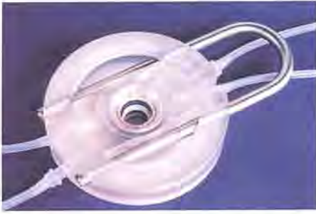
Abb. 5: Mikroskopkammer für Perfusionskulturen: Zellen oder Gewebe lassen sich entweder peripher auf den gläsernen Abdeckungen oder im Zentrum der Kammer auf dem MINUSHEET-Zellträger kultivieren. Dadurch können Kulturen plan oder dreidimensional expandiert werden. Zudem können mit dieser Methode Epithelien von unten und oben mit ganz unterschiedlichen Medien durchströmt werden.
