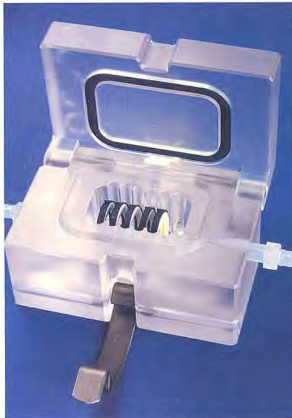
Abb. 3: Perfusionscontainer; nach dem Anwachsen der Zellen auf den MINUSHEETS, werden sie in Kulturcontainer eingesetzt, die permanent mit frischem Medium durchströmt werden.
